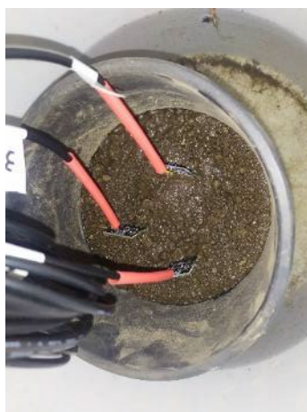
Immagine 19 e 20: Centraline per la registrazione dei dati, dotata di tre sensori di temperatura e tre sensori di umidità del suolo e corredata di pannellino fotovoltaico per l'autonomia energetica. A destra, una delle centraline in fase di test installata vicino ad altre apparecchiature meteorologiche nel Campus di ricerca di Cadenazzo.
