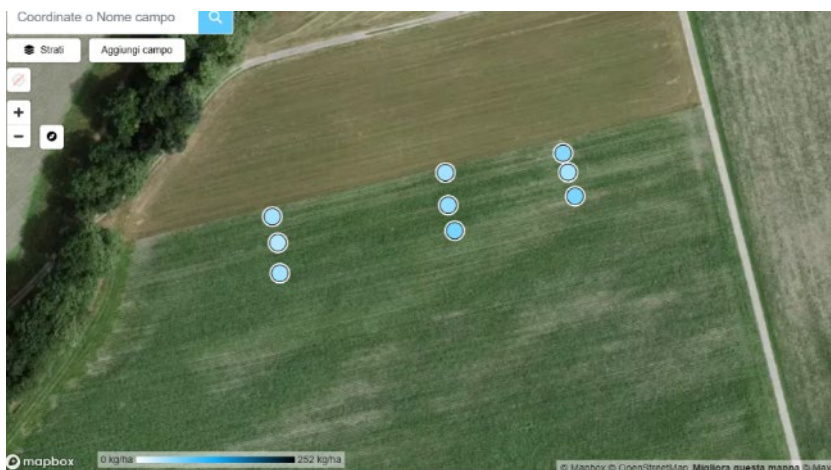
Immagine 2: punti rilievo misurati con la sonda FarmLab della ditta STENON, ogni punto corrisponde a tre misurazioni. La posizione dei punti è indicativa, ma non esaustiva, in quanto rilevata dal GPS interno della sonda, il quale non offre una precisione molto elevata.
