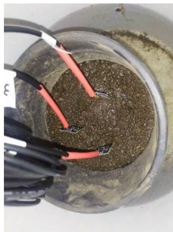
**Image 21 et 22 :** les deux échantillons de sol utilisés pour le calibrage des capteurs de l'unité de contrôle. Dans le seau blanc, l'échantillon saturé d'eau (100 % d'humidité) à côté de l'échantillon complètement sec (0 % d'humidité). Image (droite) phase d'étalonnage des sondes insérées dans l'échantillon humide.
