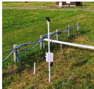
**Image 19 et 20 :** Unité de contrôle d'enregistrement de données, équipée de trois capteurs de température et de trois capteurs d'humidité du sol et équipée d'un panneau photovoltaïque pour l'autonomie énergétique. À droite, l'une des unités de contrôle en cours de test installée à proximité d'autres équipements météorologiques du Campus de Recherche de Cadenazzo.
